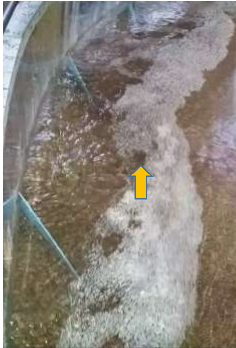
شکل ۵- نمایش منحرف شدن جریان به میانه فلوم در اطراف سری صفحات شکافدار در فاصله‌ی 8Le با استفاده از خاکاره
