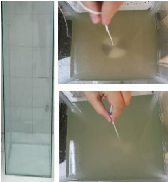
شکل ۱- مخزن شبیه‌سازی شده برای اندازه‌گیری عمق دیسک سکی
