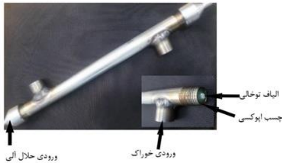
شکل ۱- ماژول تماس دهنده غشایی مایع-مایع
