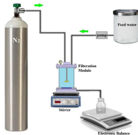
شکل ۱- شماتیک سیستم جداسازی انتها بسته
