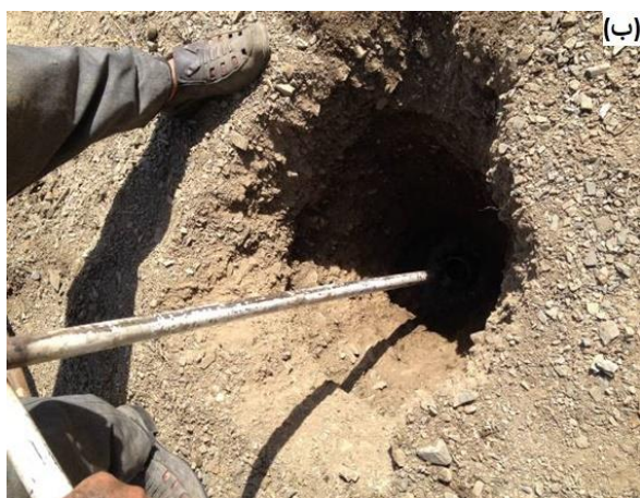
شکل ۲- انجام رسوب‌سنجی در مخازن رسوب: الف- شبکه‌بندی مخزن رسوب ب- حفر پروفیل با اوگر
