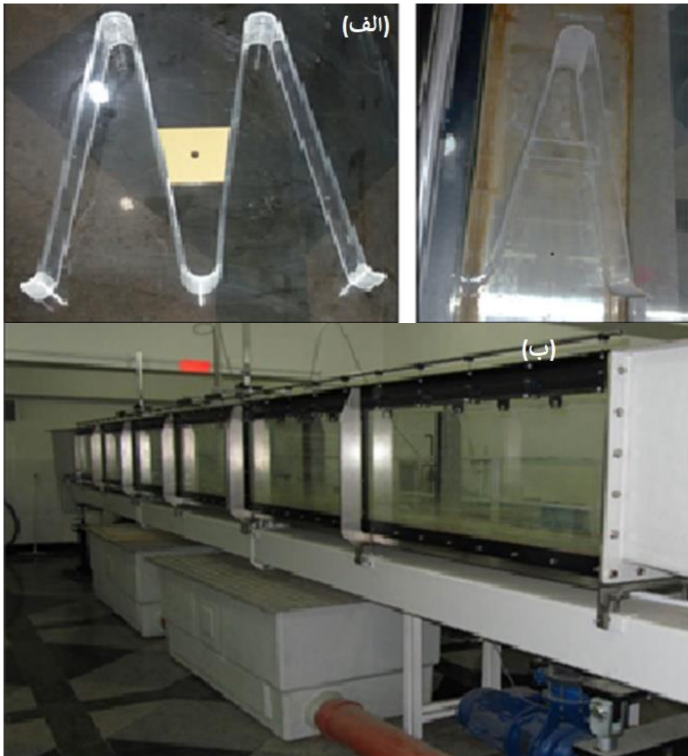
شکل ۲- نمای کلی از تجهیزات و فلوم آزمایشگاهی مورد استفاده در آزمایشگاه: الف)- سرریزهای زیگزاگی قوسی تک سیکل و دو سیکل و ب)- فلوم آزمایشگاهی مستطیلی
