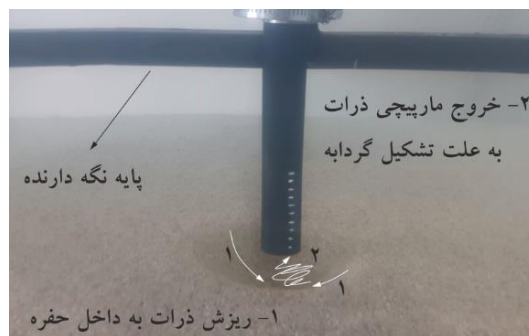
شکل ۴- تشکیل گردابه‌ها در زیر دهانه مکش ( F_r = 4/15 ) و Z/d = 0
