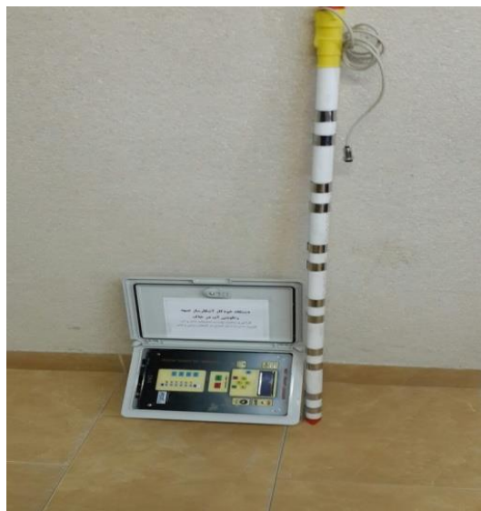
شکل ۱- دستگاه اندازه‌گیری جبهه رطوبتی آب در خاک Fig.1 Soil moisture front measurement instrument
