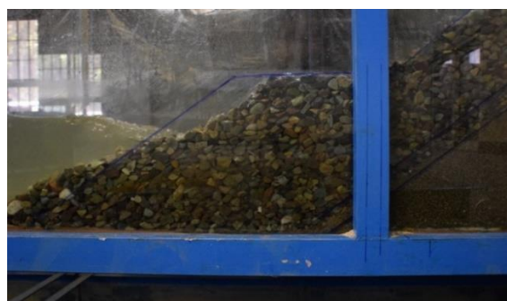
شکل ۲- مقطعی از مدل اجراشده از موج‌شکن سکویی داخل فلوم موج
