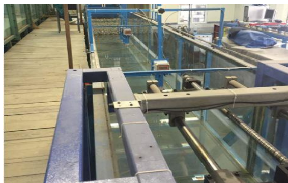
شکل ۱- تصویری از فلوم موج آزمایشگاه هیدرولیک دانشگاه تربیت مدرس
